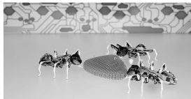
[그림 1.14] FESTO 개미 로봇 동물 · 곤충의 구조와 구동 메커니즘을 모방(Bio-inspired).
