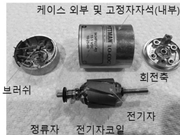
[그림 1.20] DC 모터의 회전 원리 및 내부 구조(정류자·브러시·전기자)
